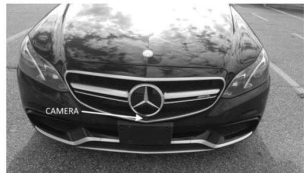
Fig 6: Cámara delantera
