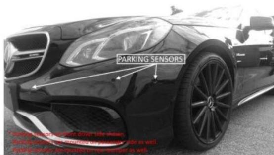
Fig 5: Sensores de parachoques
