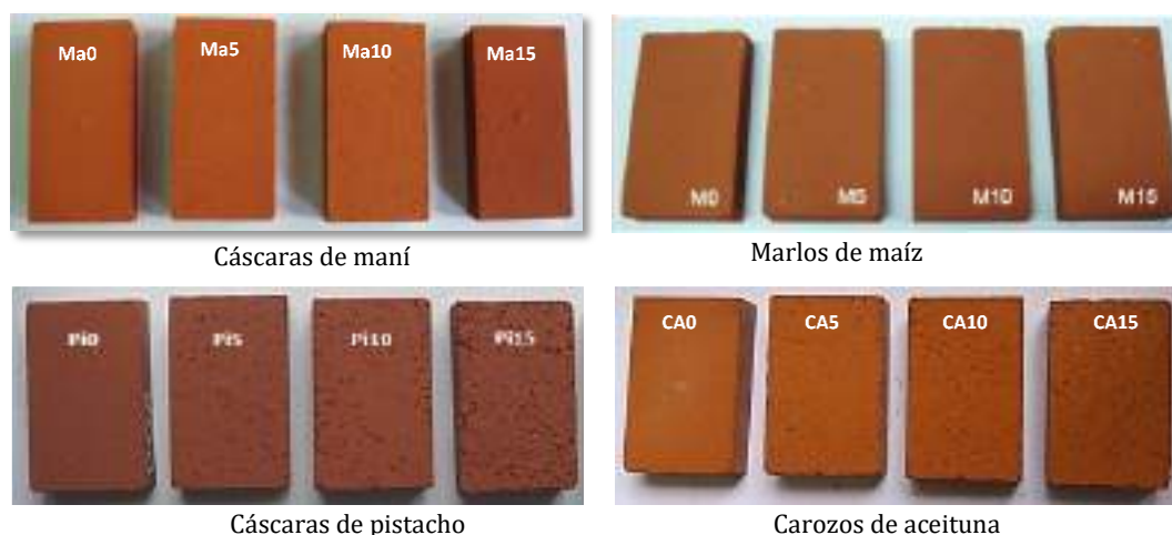
Figura 1. Ladrillos cerámicos obtenidos con diversas biomásas agregadas.
