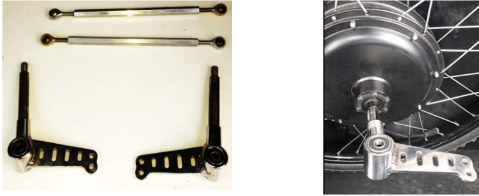
Figura 8: Izquierda: kit común de dirección para karting, utilizado en el prototipo. Derecha: Adaptación de las manguetas a los ejes de las ruedas motorizadas. Fuente: Elaboración propia.
