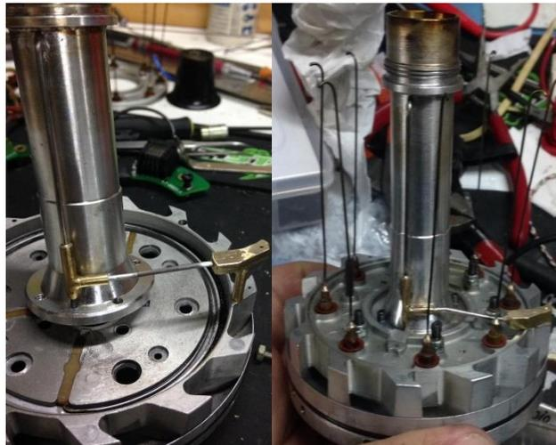
Figura 5 Nueva cañería de lubricación y montaje
