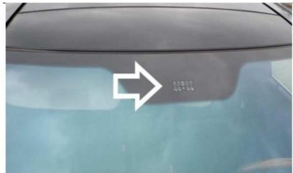
Fig 4: Cámara montada en el parabrisas y sensores
