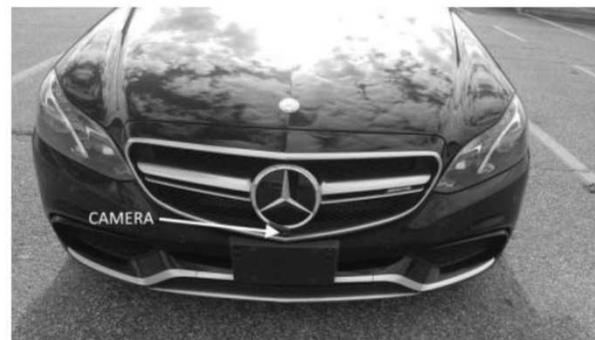
Fig 6: Cámara delantera
