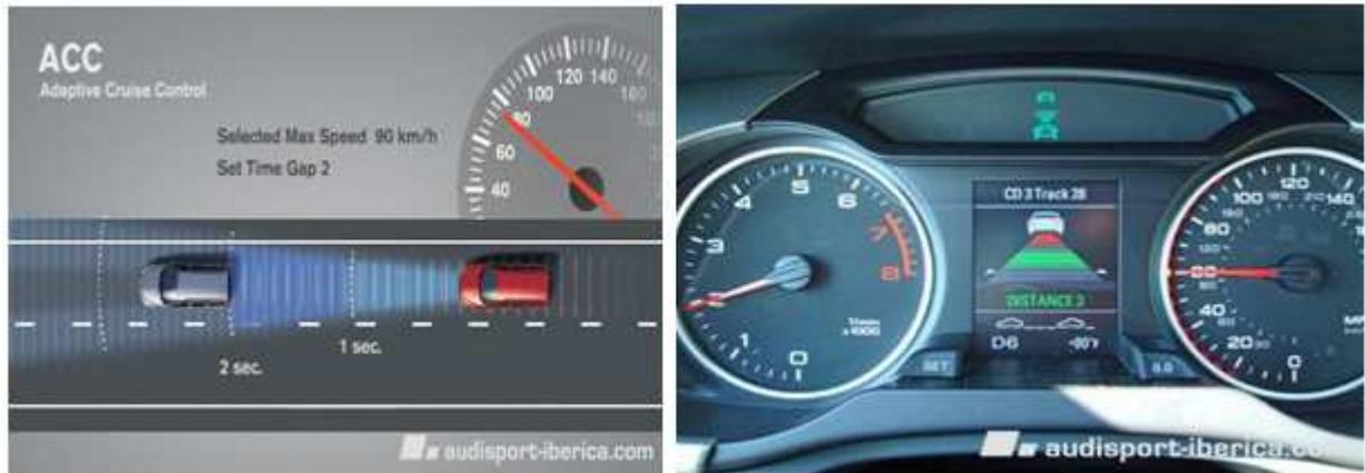
Figura 1 *Adaptive Cruise Control (ACC o AAC) regula la velocidad seleccionada teniendo en cuenta la distancia con respecto al vehículo precedente entre 30 y 200 km/h, reaccionando ante vehículos que se encuentran a una distancia de hasta 180 metros.* Fuente: <https://www.audisport-iberica.com/foro/topic/219939-adaptive-cruise-control-acc-y-braking-guard/>
